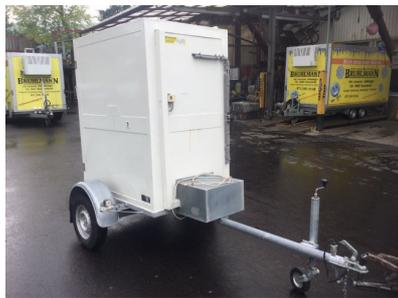
Kühlanhänger mit Kühlaggregat
