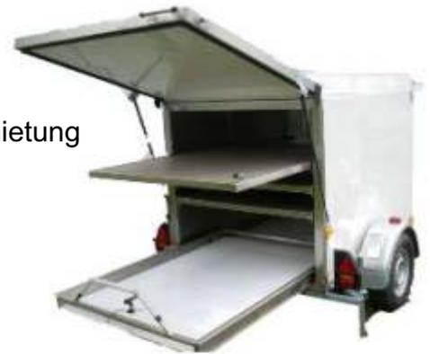
Lebensmittelechter Innenraum für eine hygienische Lagerung von Lebensmitteln, leichtgängige Heckklappe mit Gasfederunterstützung, speziell weich-gefederte Gummifederachse für ruhigen Lauf
