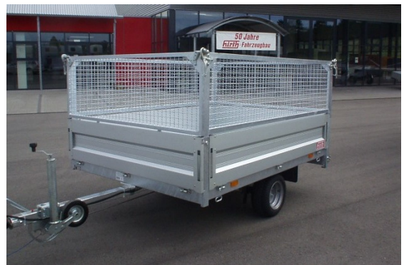
stabiler Maschengitteraufsatz, verzinkt mit soliden Pendelverschlüssen
