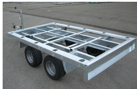
Rahmen in Schweißkonstruktion feuerverzinkt im Tauchbad (Serie)
