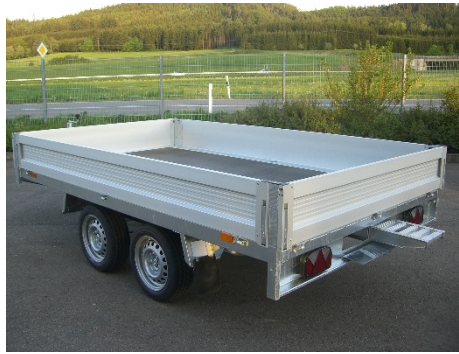
Rampentunnel unter der Pritsche
