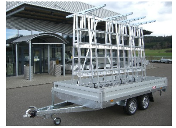
Glasgestell auf Anhänger montiert
