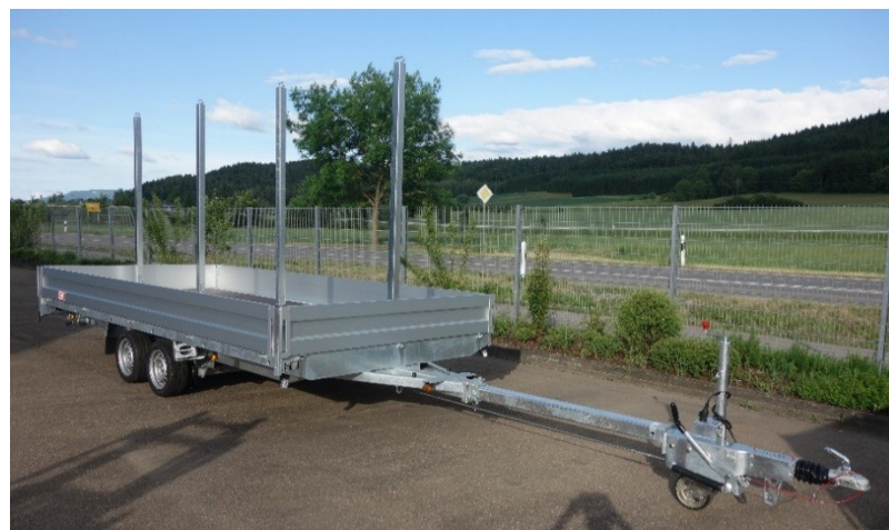
Option: Steckungen mit Exzenterverschluss, ideal für den Transport hoher Elemente
