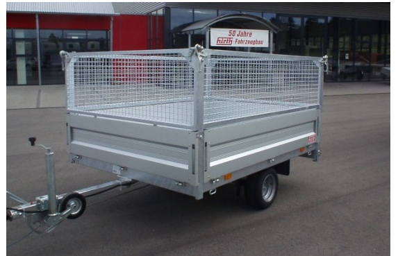
stabiler Maschengitteraufsatz, verzinkt mit soliden Pendelverschlüssen
