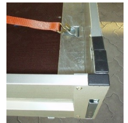
* Zurrbügel im Viel- loch-Rahmenprofil
