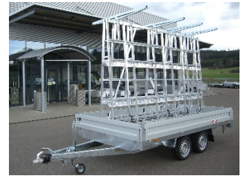
Glasgestell auf Anhänger montiert
